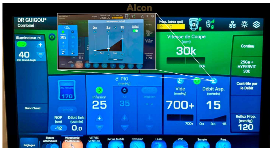
Figure 3. Unity VCS® accélère l'aspiration en cas d'occlusion partielle ou complète, afin d'avoir une montée en vide plus rapide que sur des pompes péristaltiques standards grâce à l'algorithme Intelligent Aspiration® et permet ainsi d'opérer en mode « contrôle de débit » tout en atteignant des valeurs de vide plus élevées.
